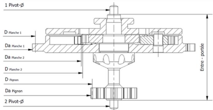
Unser leistungsstarkes Hilfs-Umkehrrad garantiert höchste Präzision und Zuverlässigkeit besonders auf Grund des Feller-Roulages und der neusten REACH konformen Materialien. Durch den Einsatz des Satellitenprinzipes wird der "Angle-Mort" deutlich verringert dies führt zu einem effizienteren Aufzug des Federhauses.
